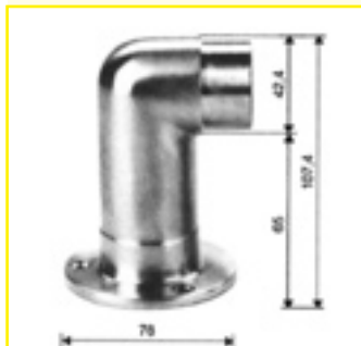
Ancoraggio lungo Cod. EX100
